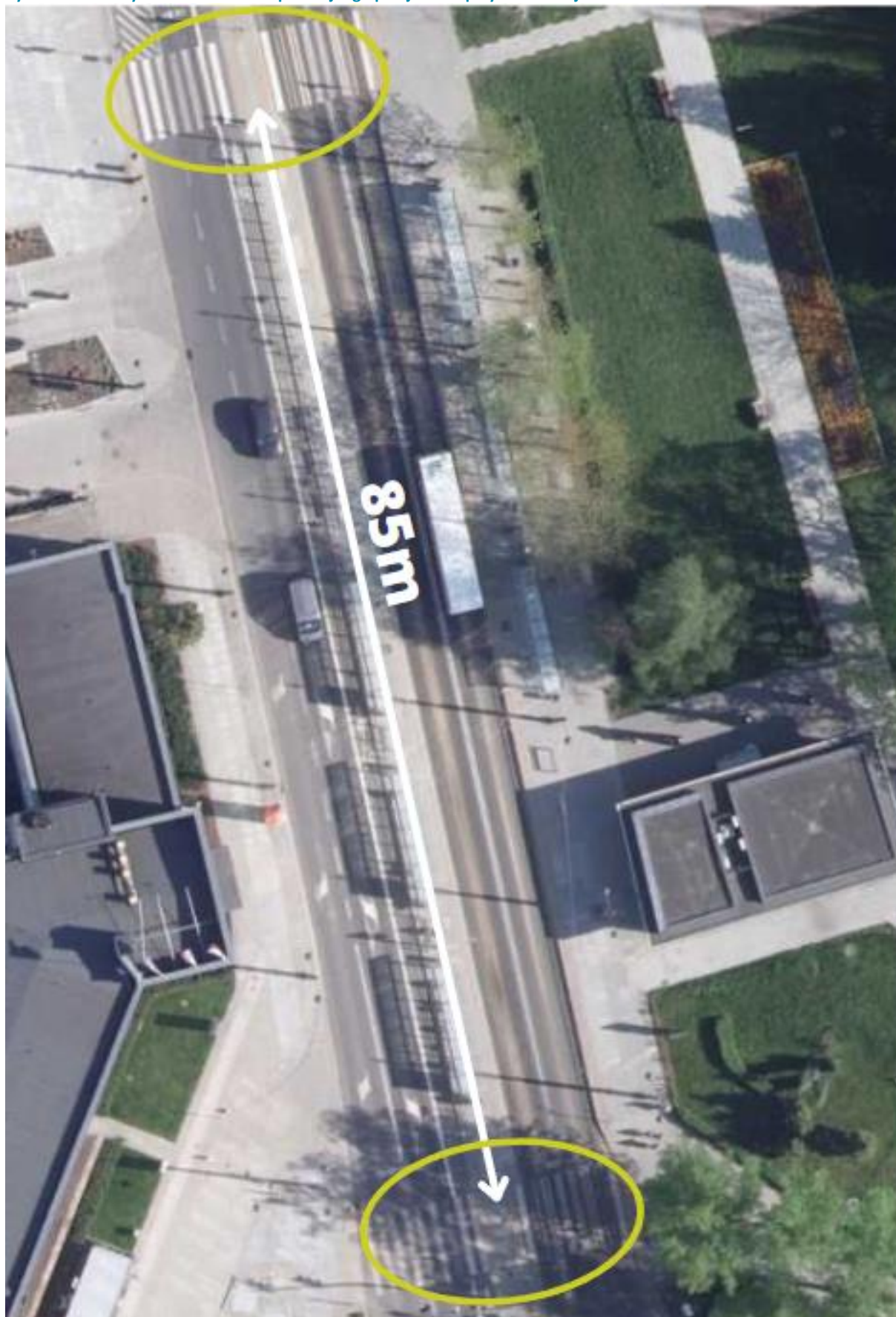
Rysunek 114. Przykład zastosowania podwójnego przejścia na przystanku Aleja Solidarności.
